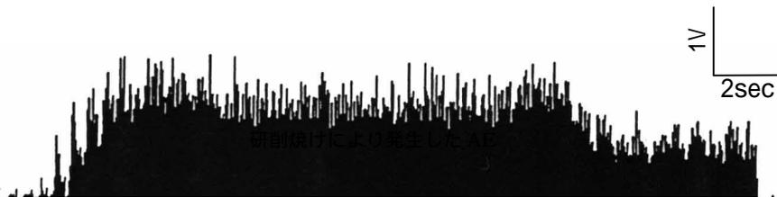
a) 正常研削時のAE信号
